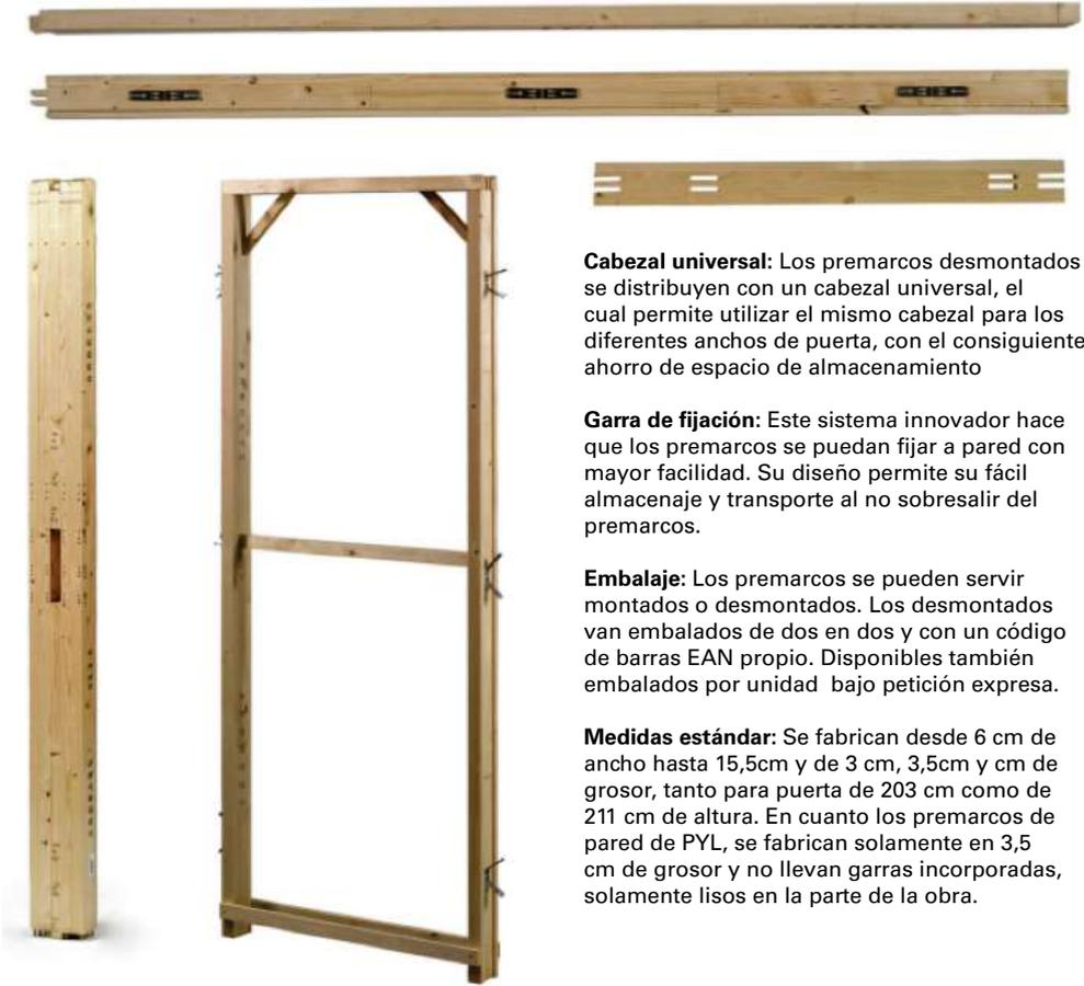
**Cabezal universal:** Los premarcos desmontados se distribuyen con un cabezal universal, el cual permite utilizar el mismo cabezal para los diferentes anchos de puerta, con el consiguiente ahorro de espacio de almacenamiento
